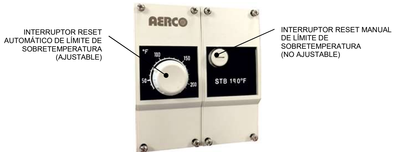
Figura 4-9: Ubicación de interruptor de límite de sobretemperatura
