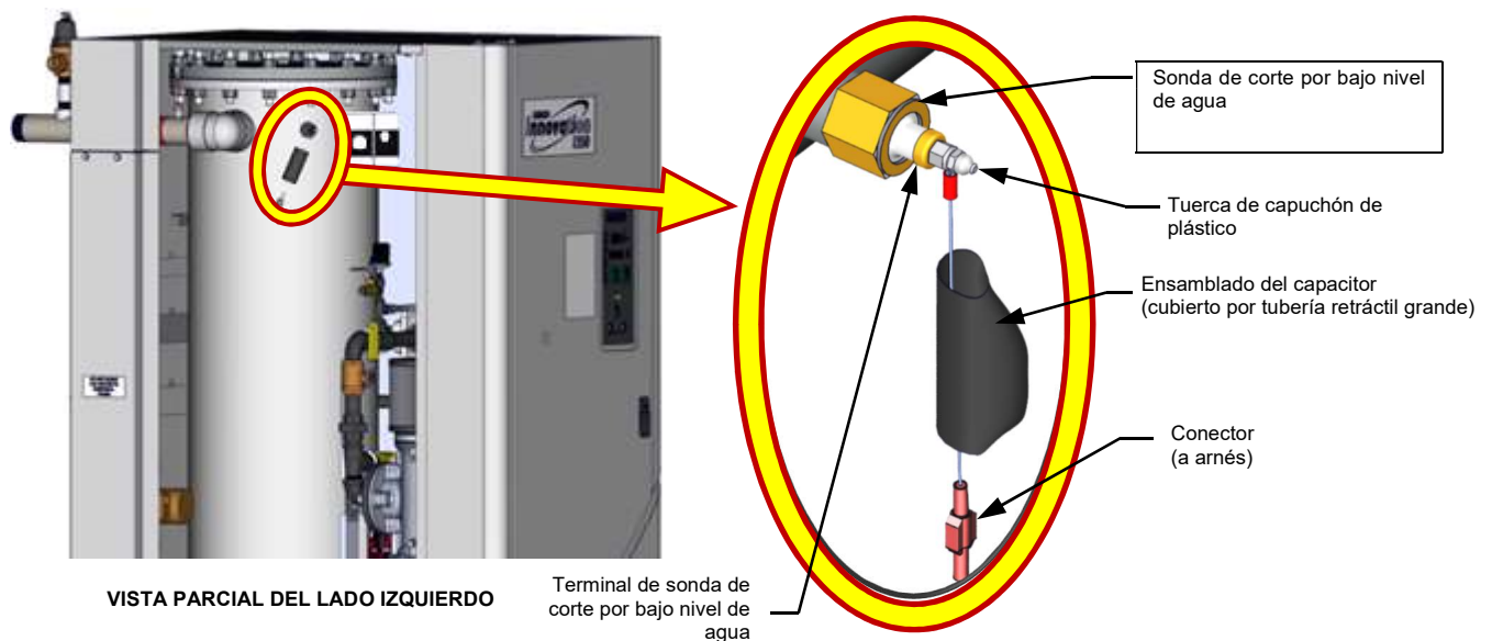
Figura 6-12: Ubicación de la sonda del interruptor de corte por bajo nivel de agua (se muestra INN 1350)
