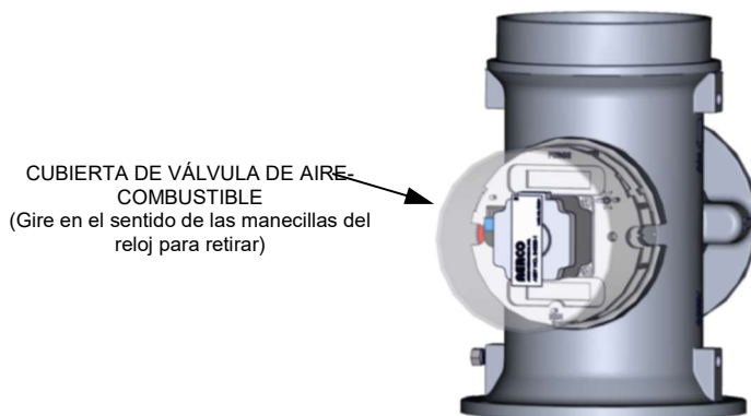
Figura 5-7: Ubicación típica de la cubierta de la Válvula de Aire-Combustible
