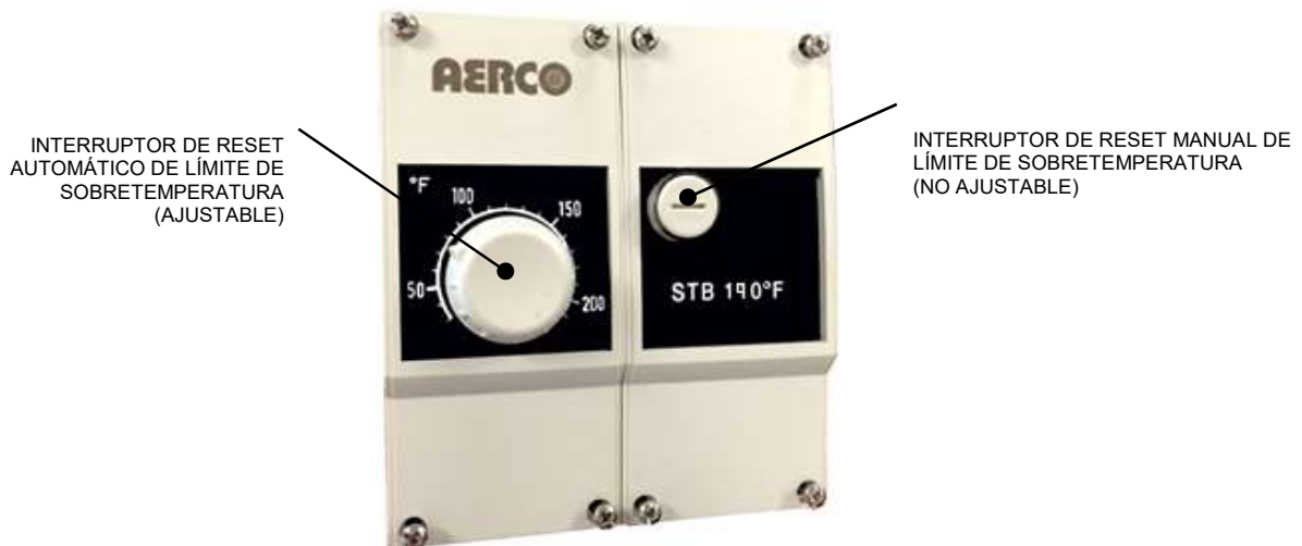
Figura 5-2: Configuración del interruptor de límite de sobretemperatura
