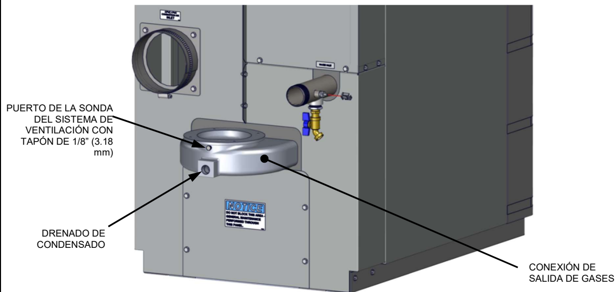
Figura 4-2: Ubicación de los orificios para la sonda del analizador
