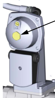
Figura 4-5: ubicación del tornillo de ajuste de presión de gas de la SSOV
