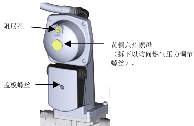
图 5-3: 具有燃气压力调节功能的SSOV执行器 (SKP25)
